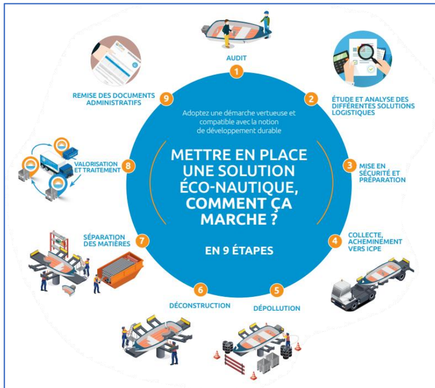
Figure 12 : Les étapes de déconstruction d'un bateau [SCLAVO]
