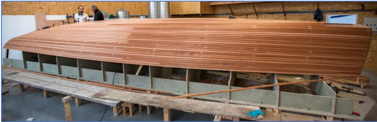
Figure 54 : La construction d'un bateau en bois avec la méthode du strip-planking
